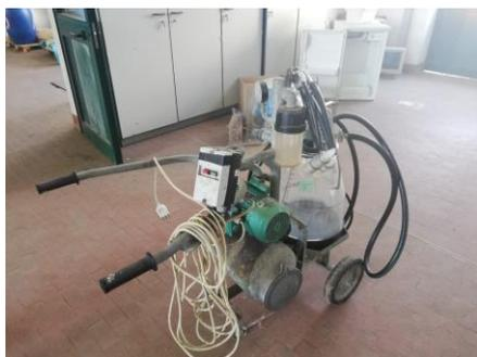
Fig. 1. Mungitrice a vaso misuratore
