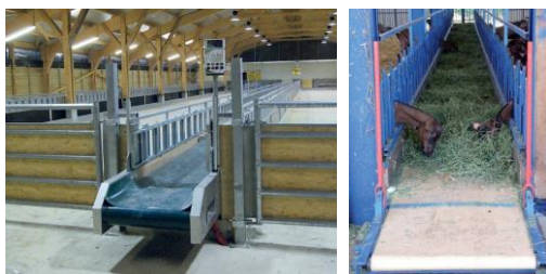
Fig. 2. Esempi di nastro per la distribuzione dei foraggi (Fonte catalogo Bayle Industries a sx, catalogo Gabard Système a dx)
