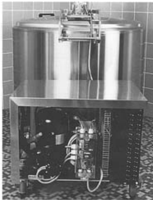
A sinistra: fig. 69. Vista posteriore di un serbatoio refrigerante con gruppo frigorifero compatto. In alto: fig. 70. Sistema di controllo elettronico programmabile.
