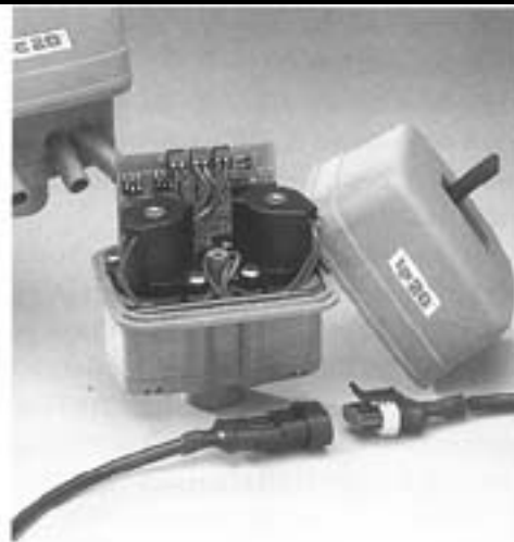
A sinistra: Fig. 27. Il pulsatore pneumatico rappresenta la soluzione più funzionale per gli impianti a secchio o mobili (Fonte Manus).
