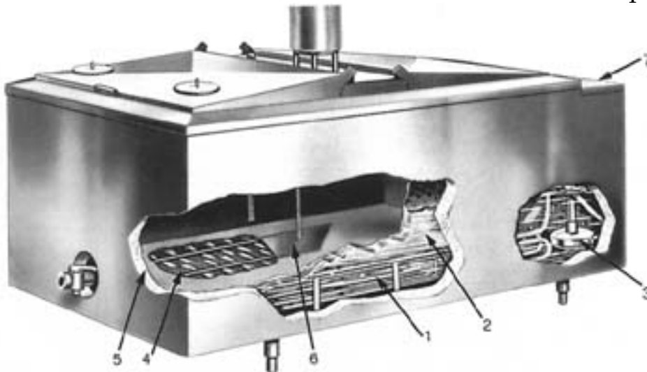
Fig. 61. Vasca refrigerante ad aspersione di acqua ghiacciata: 1) evaporatore; 2) riserva di acqua ghiacciata; 3) pompa di circolazione dell'acqua; 4) ugelli; 5) strato coibente; 6) agitatore; 7) pozzetto d'ispezione.
