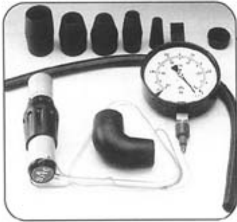
Fig. 85. Strumentazione utilizzata per il controllo in azienda degli impianti di mungitura: flussometro (a sinistra) e vuotometro (a destra). (Fonte Bonsaglia Macchine).
