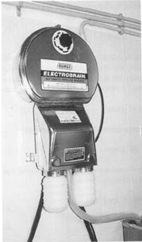
Fig. 44. Lavatrice automatica (Fonte Surge). Le soluzioni di lavaggio devono muoversi all'interno delle condutture con elevata turbolenza.
