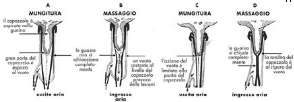
Fig. 26. Nei casi A e B sono esemplificate le conseguenze della non perfetta chiusura della guaina a causa del cattivo funzionamento del pulsatore. I casi C e D illustrano come deve funzionare la guaina per non provocare irritazioni o lesioni al capezzolo.
