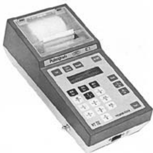
In alto: fig. 86. L'asometro viene utilizzato per misurare l'immissione o le perdite d'aria nel gruppo prendicapezzoli. Sotto: fig. 87. Pulsografo elettronico a due canali (Fonte MIBO).
