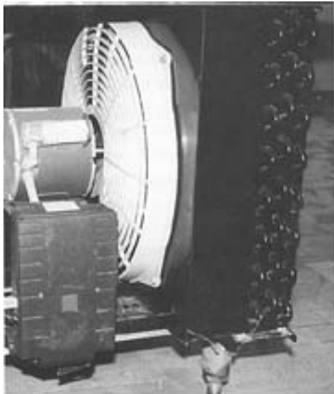
Fig. 56. Condensatore ad aria e ventilatore.
