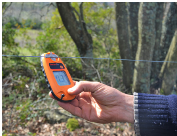
Figura 15 - Tester per controllo voltaggio
