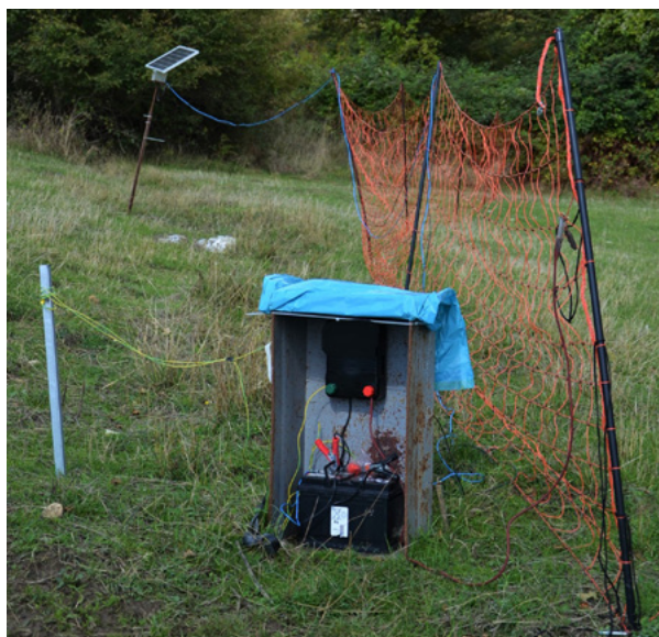
Figura 9 - Elettrificatore con pannello solare
